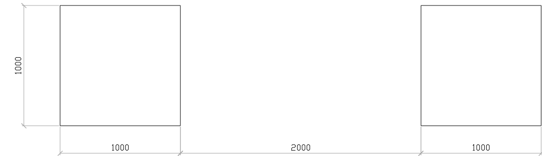
龙门及双柱独立基础基坑平面图
